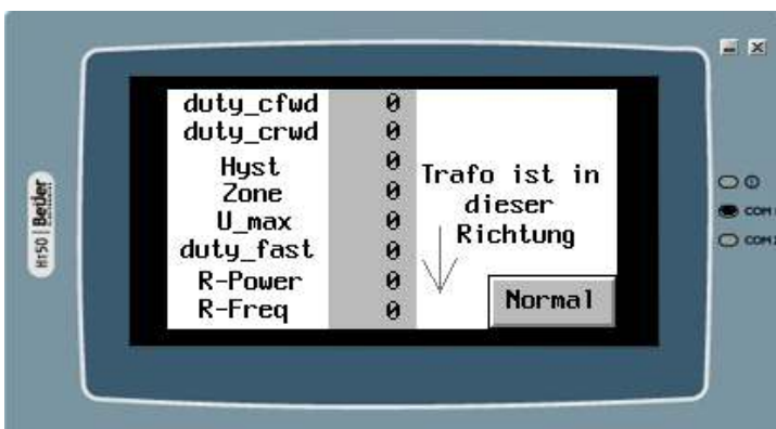
Fenster Potis: Hier können die Werte der entsprechenden Potis angezeigt werden und damit einfach und nachvollziehbar eingestellt werden.
